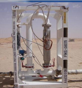
**Figure 1: Représente un débit mètre (Coriolis).**
