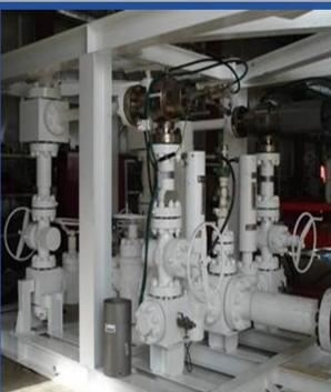
**Figure 2: Représente choke manifold.**
