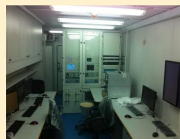
Le suivi des paramètres de forage en temps réel est assuré par l'équipe du Mudlogging, à l'aide des capteurs installé dans les différents endroits.
